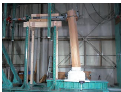
奈良県森林技術センターにて直径36cmの樺柱の実物大実験
